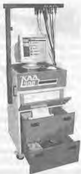
2.33-rasm. KAD-400 rusumli dvigatellarni kompyuterli diagnostikalash kompleksi (KAD-400 ning tarkibiga shaxsiy kompyuter; motor-testor; skaner MT-2E, ossillograf MO-2 va generator GS-1 kiradi. MT-2E kompyuter skaneri «BA3», «TA3» va «YA3» avtomobillarining elektron boshqarish bloki tizimini nazorat etish uchun mo'ljallangan).
