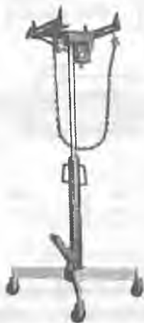
2.10-rasm. Transmissiya agregatlari uchun harakatlanuvchi ustun (rusumi 5.1206; yuk ko'tarish qobiliyati 600 kg; ko'tarib olish balandligi 1125 mm; ko'tarish balandligi 1950 mm; tashqi o'lchamlari 375x305x112 mm; og'irligi 49 kg).
