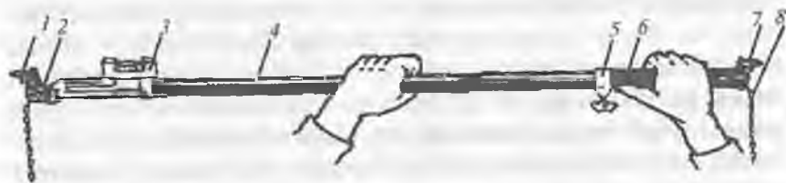
3.46-rasm. Yaqinlashuv burchaklarini sozlash lineykasi shakli.
