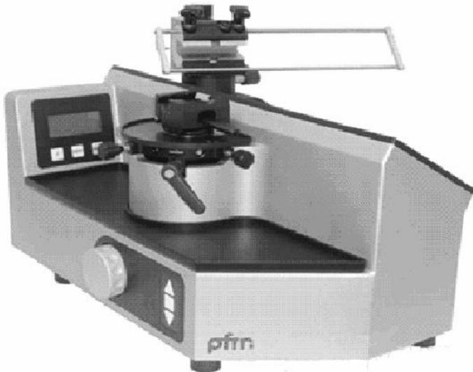
Рис. I.5. Электрический санный микротом “PFM Slide 4003 E”
