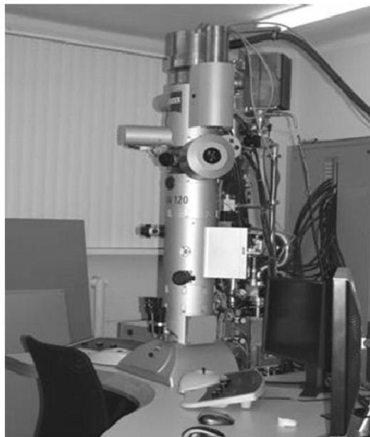
Рис. I.1. Электронный микроскоп (ЭМ) – прибор, позволяющий получать изображение объектов с максимальным увеличением до  $10^6$  раз, благодаря использованию вместо светового потока пучка электронов с энергиями 30–200 кЭв и более. Разрешающая способность электронного микроскопа в 1000–10000 раз превосходит разрешение светового микроскопа и для лучших современных приборов может составлять несколько ангстрем
