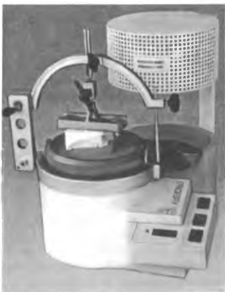
4.17-расм. Хусусий қошиқчалар тайёрланадиган аппарат.
