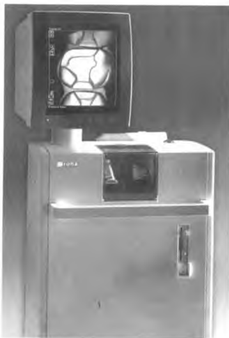
1.12-расм. Чинни қистирмаларнинг тайёрланиши (Церек тизими).
