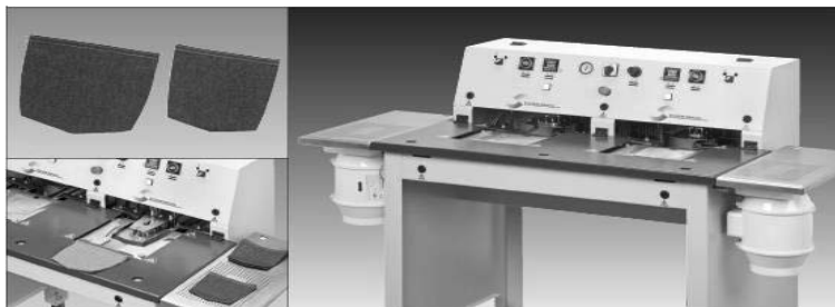
6.16-rasm. 906-01 –Jins shimidagi ort qoplama cho‘ntakni chok xaqalarinin bukib presslash.
