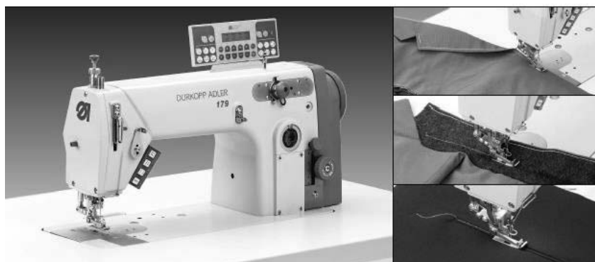
4.40-rasm. “DURKOPP ADLER” 179-171629 – Erkaklar pidjagi bort, yoqa, cho'ntak og'zi qiriqlarini vaqtinchalik biriktirishga mo'ljallangan dasturlashtirilgan tikuv mashinasi
