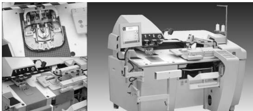
2.25-rasm. 806N-121-01 – Erkaklar sorochkasida qoplama cho‘ntak tikish avtomati.
