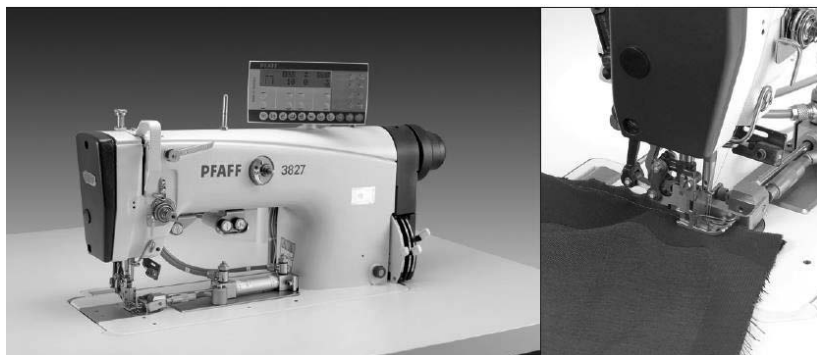
4.39-rasm. “PFAFF” -3827 – Erkaklar pidjagida yelka va yon qiriqlarini biriktirib tikishga mo'ljallangan dasturlashtirilgan tikuv mashinasi.
