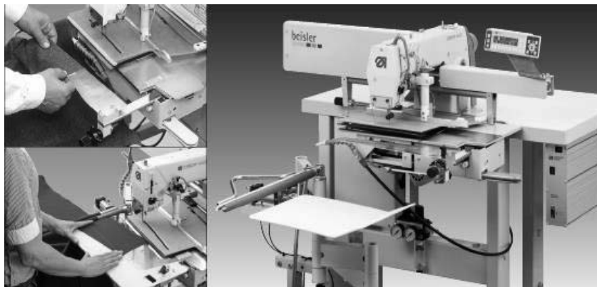
3.52-rasm. 743-121-01 Erkaklar shimida vitachka va taxlamalarni tikish avtomati.
