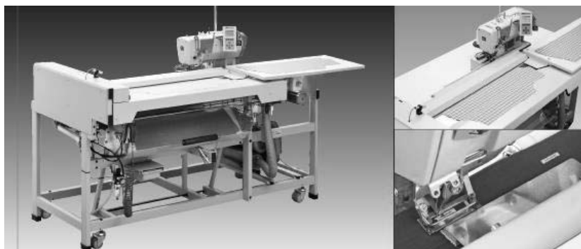
2.26-rasm. 841-100-01 INDEXER – Erkaklar ko‘ylagida planka hosil qilib izma ochish avtomati.
