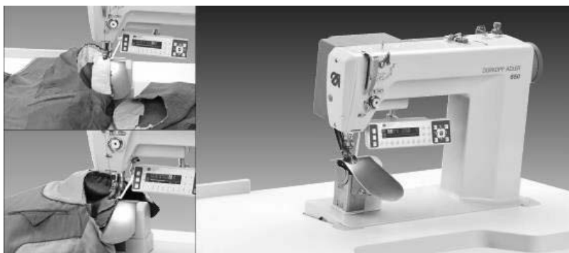
4.37-rasm. “DURKOPP ADLER” 650-10 OP3000 – Erkaklar pidjagida yeng o‘mizini o‘tkazishga dasturlashtirilgan tikuv mashinasi.
