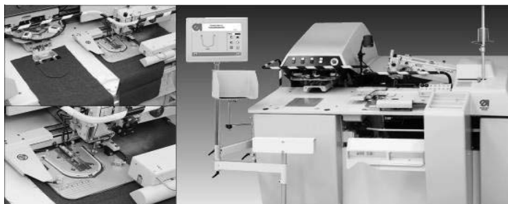
6.18-rasm. . 806N-111-01 –Qoplama cho‘ntakka ishlov beruvchi avtomat mashinasi.
