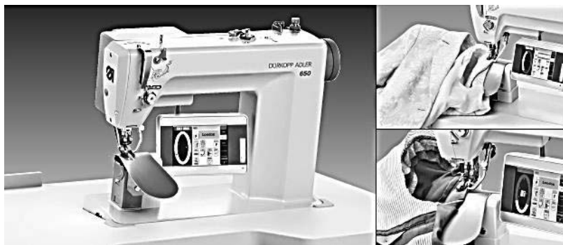
4.41-rasm. “DURKOPP ADLER” 650-10 OP7000 – Erkaklar pidjagi yengni yeng o‘miziga biriktirib tikishga mo‘ljallangan dasturlashtirilgan tikuv mashinasi.
