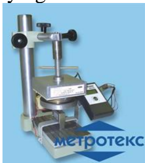
1.96-rasm. MT-420 elektr qarshiligini aniqlash asbobi.
